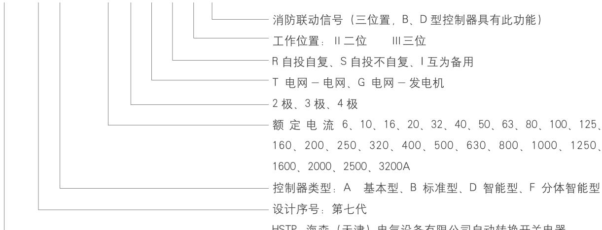
HSTP: 海森(天津)电气设备有限公司自动转换开关电器
